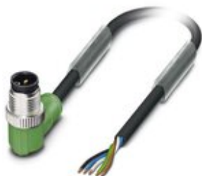
Sensor-/Aktor-Kabel, 5-polig, PVC, schwarz RAL 9005, Stecker gewinkelt M12, Kodierung: A, auf freies Leitungsende, Kabellänge: 10 m
