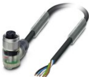
Sensor-/Aktor-Kabel, 5-polig, PVC, schwarz RAL 9005, freies Leitungsende, auf Buchse gewinkelt M12, Kodierung: A, mit 3 LEDs, Kabellänge: 1,5 m
