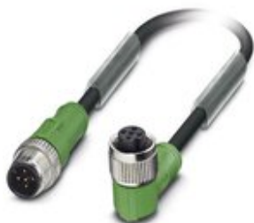
Sensor-/Aktor-Kabel, 5-polig, PVC, schwarz RAL 9005, Stecker gerade M12, Kodierung: A, auf Buchse gewinkelt M12, Kodierung: A, Kabellänge: 1,5 m
