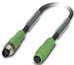
Sensor-/Aktor-Kabel, 3-polig, PUR halogenfrei, schwarzgrau RAL 7021, Stecker gerade M8, auf Buchse gerade M8 Snap-In, Kabellänge: 1 m
