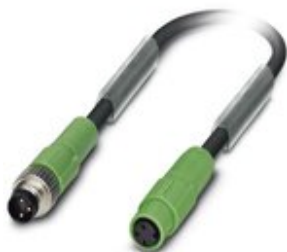
Sensor-/Aktor-Kabel, 3-polig, PUR halogenfrei, schwarzgrau RAL 7021, Stecker gerade M8, auf Buchse gerade M8 Snap-In, Kabellänge: 3 m
