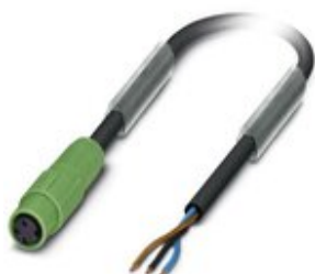
Sensor-/Aktor-Kabel, 3-polig, PUR halogenfrei, schwarzgrau RAL 7021, freies Leitungsende, auf Buchse gerade M8 Snap-In, Kabellänge: 2 m
