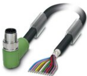
Sensor-/Aktor-Kabel, 12-polig, PUR/PVC, schwarz RAL 9005, geschirmt, Stecker gewinkelt M12 SPEEDCON, Kodierung: A, auf freies Leitungsende, Kabellänge: 3 m
