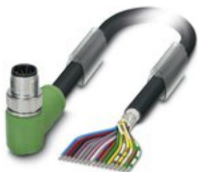
Sensor-/Aktor-Kabel, 17-polig, PUR/PVC, schwarz RAL 9005, geschirmt, Stecker gewinkelt M12 SPEEDCON, Kodierung: A, auf freies Leitungsende, Kabellänge: 5 m
