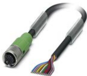
Sensor-/Aktor-Kabel, 12-polig, PUR halogenfrei, schwarz RAL 9005, freies Leitungsende, auf Buchse gerade M12 SPEEDCON, Kodierung: A, Kabellänge: 1,5 m
