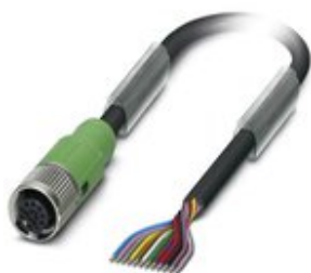
Sensor-/Aktor-Kabel, 12-polig, PUR halogenfrei, schwarz RAL 9005, freies Leitungsende, auf Buchse gerade M12 SPEEDCON, Kodierung: A, Kabellänge: 3 m
