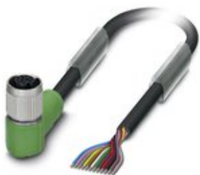
Sensor-/Aktor-Kabel, 12-polig, PUR halogenfrei, schwarz RAL 9005, freies Leitungsende, auf Buchse gewinkelt M12 SPEEDCON, Kodierung: A, Kabellänge: 1,5 m
