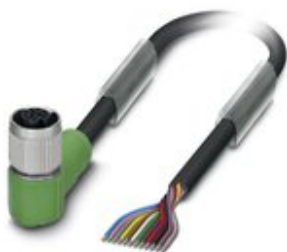
Sensor-/Aktor-Kabel, 12-polig, PUR halogenfrei, schwarz RAL 9005, freies Leitungsende, auf Buchse gewinkelt M12 SPEEDCON, Kodierung: A, Kabellänge: 10 m
