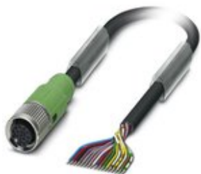
Sensor-/Aktor-Kabel, 17-polig, PUR halogenfrei, schwarz RAL 9005, freies Leitungsende, auf Buchse gerade M12 SPEEDCON, Kodierung: A, Kabellänge: 5 m
