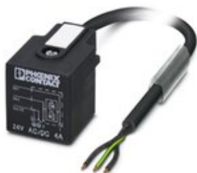
Sensor-/Aktor-Kabel, 3-polig, PUR halogenfrei, schwarzgrau RAL 7021, freies Leitungsende, auf Ventilstecker A, mit 1 LED, beschaltet mit Z-Diode, Kabellänge: 10 m
