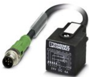
Sensor-/Aktor-Kabel, 5-polig, PUR halogenfrei, schwarzgrau RAL 7021, Stecker gerade M12 SPEEDCON, Kodierung: A, auf Ventilstecker AD (Druckschalter), mit 2 LEDs, Kabellänge: 0,3 m
