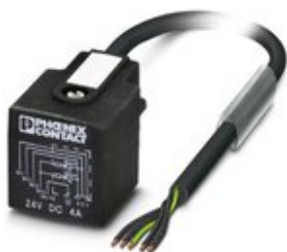
Sensor-/Aktor-Kabel, 5-polig, PUR halogenfrei, schwarzgrau RAL 7021, freies Leitungsende, auf Ventilstecker AD (Druckschalter), mit 2 LEDs, Kabellänge: 5 m
