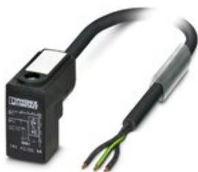
Sensor-/Aktor-Kabel, 3-polig, PUR halogenfrei, schwarzgrau RAL 7021, freies Leitungsende, auf Ventilstecker C (8 mm), mit 1 LED, beschaltet mit Z-Diode, Kabellänge: 1,5 m
