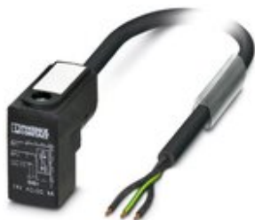
Sensor-/Aktor-Kabel, 3-polig, PUR halogenfrei, schwarzgrau RAL 7021, freies Leitungsende, auf Ventilstecker C (8 mm), mit 1 LED, beschaltet mit Z-Diode, Kabellänge: 10 m
