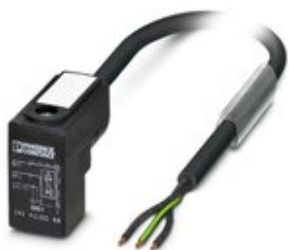
Sensor-/Aktor-Kabel, 3-polig, PUR halogenfrei, schwarzgrau RAL 7021, freies Leitungsende, auf Ventilstecker CI (9,4 mm), mit 1 LED, beschaltet mit Z-Diode, Kabellänge: 10 m
