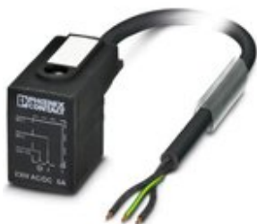
Sensor-/Aktor-Kabel, 3-polig, PUR halogenfrei, schwarzgrau RAL 7021, freies Leitungsende, auf Ventilstecker BI (11 mm), Kabellänge: 10 m
