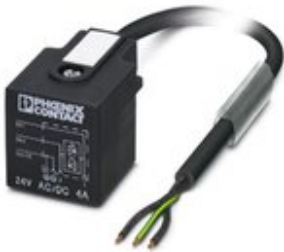
Sensor-/Aktor-Kabel, 3-polig, PVC, schwarz RAL 9005, freies Leitungsende, auf Ventilstecker A, mit 1 LED, beschaltet mit Z-Diode, Kabellänge: 5 m
