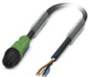
Sensor-/Aktor-Kabel, 4-polig, PUR halogenfrei, schwarzgrau RAL 7021, Stecker gerade M12, Kodierung: A, auf freies Leitungsende, Kabellänge: 5 m, mit Kunststofffrädel
