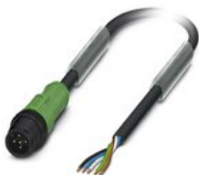
Sensor-/Aktor-Kabel, 5-polig, PUR halogenfrei, schwarzgrau RAL 7021, Stecker gerade M12, Kodierung: A, auf freies Leitungsende, Kabellänge: 3 m, mit Kunststofffrädel
