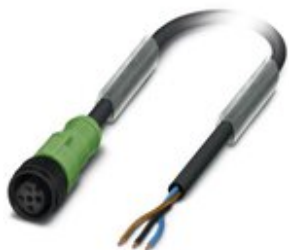
Sensor-/Aktor-Kabel, 3-polig, PUR halogenfrei, schwarzgrau RAL 7021, freies Leitungsende, auf Buchse gerade M12, Kodierung: A, Kabellänge: 10 m, mit Kunststoffrändel
