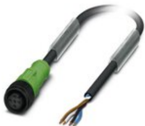
Sensor-/Aktor-Kabel, 4-polig, PUR halogenfrei, schwarzgrau RAL 7021, freies Leitungsende, auf Buchse gerade M12, Kodierung: A, Kabellänge: 5 m, mit Kunststoffrändel
