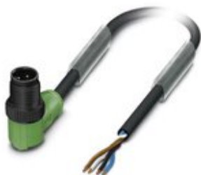
Sensor-/Aktor-Kabel, 4-polig, PUR halogenfrei, schwarzgrau RAL 7021, Stecker gewinkelt M12, Kodierung: A, auf freies Leitungsende, Kabellänge: 5 m, mit Kunststofffrädel
