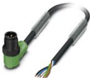
Sensor-/Aktor-Kabel, 5-polig, PUR halogenfrei, schwarzgrau RAL 7021, Stecker gewinkelt M12, Kodierung: A, auf freies Leitungsende, Kabellänge: 1,5 m, mit Kunststoffrändel
