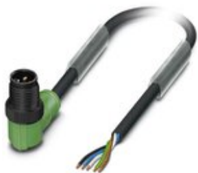
Sensor-/Aktor-Kabel, 5-polig, PUR halogenfrei, schwarzgrau RAL 7021, Stecker gewinkelt M12, Kodierung: A, auf freies Leitungsende, Kabellänge: 3 m, mit Kunststofffränsel
