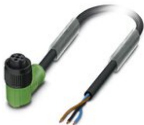
Sensor-/Aktor-Kabel, 3-polig, PUR halogenfrei, schwarzgrau RAL 7021, freies Leitungsende, auf Buchse gewinkelt M12, Kodierung: A, Kabellänge: 5 m, mit Kunststoffrändel
