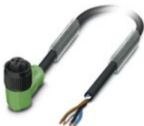
Sensor-/Aktor-Kabel, 4-polig, PUR halogenfrei, schwarzgrau RAL 7021, freies Leitungsende, auf Buchse gewinkelt M12, Kodierung: A, Kabellänge: 10 m, mit Kunststoffrändel
