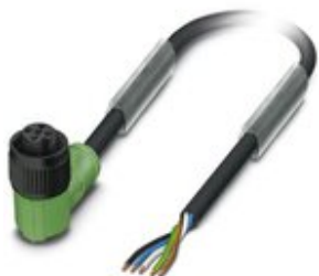
Sensor-/Aktor-Kabel, 5-polig, PUR halogenfrei, schwarzgrau RAL 7021, freies Leitungsende, auf Buchse gewinkelt M12, Kodierung: A, Kabellänge: 3 m, mit Kunststoffrändel
