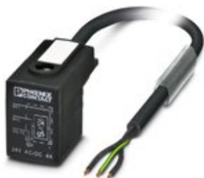
Sensor-/Aktor-Kabel, 3-polig, PUR halogenfrei, schwarzgrau RAL 7021, freies Leitungsende, auf Ventilstecker B (10 mm), mit 1 LED, beschaltet mit Varistor, Kabellänge: 1,5 m
