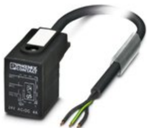
Sensor-/Aktor-Kabel, 3-polig, PUR halogenfrei, schwarzgrau RAL 7021, freies Leitungsende, auf Ventilstecker B (10 mm), mit 1 LED, beschaltet mit Varistor, Kabellänge: 10 m
