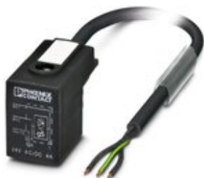
Sensor-/Aktor-Kabel, 3-polig, PUR halogenfrei, schwarzgrau RAL 7021, freies Leitungsende, auf Ventilstecker BI (11 mm), mit 1 LED, beschaltet mit Varistor, Kabellänge: 3 m
