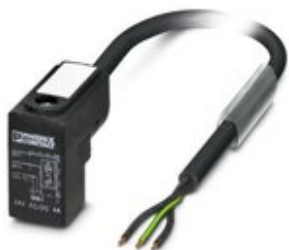
Sensor-/Aktor-Kabel, 3-polig, PUR halogenfrei, schwarzgrau RAL 7021, freies Leitungsende, auf Ventilstecker C (8 mm), mit 1 LED, beschaltet mit Varistor, Kabellänge: 3 m
