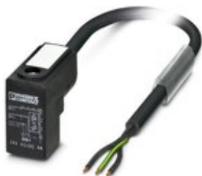
Sensor-/Aktor-Kabel, 3-polig, PUR halogenfrei, schwarzgrau RAL 7021, freies Leitungsende, auf Ventilstecker CI (9,4 mm), mit 1 LED, beschaltet mit Varistor, Kabellänge: 1,5 m
