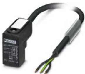
Sensor-/Aktor-Kabel, 3-polig, PUR halogenfrei, schwarzgrau RAL 7021, freies Leitungsende, auf Ventilstecker CI (9,4 mm), mit 1 LED, beschaltet mit Varistor, Kabellänge: 3 m
