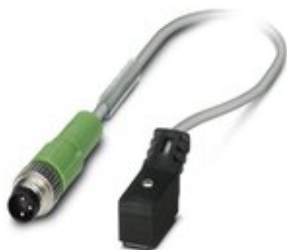
Sensor-/Aktor-Kabel, 2-polig, PUR, grau RAL 7001, Stecker gerade M8, auf Ventilstecker Festo ZC, mit 1 LED, Kabellänge: 0,3 m
