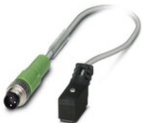
Sensor-/Aktor-Kabel, 2-polig, PUR, grau RAL 7001, Stecker gerade M8, auf Ventilstecker Festo ZC, mit 1 LED, Kabellänge: 0,6 m
