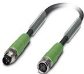
Sensor-/Aktor-Kabel, 3-polig, PUR halogenfrei, schwarzgrau RAL 7021, geschirmt, Stecker gerade M8, auf Buchse gerade M8, Kabellänge: 1,5 m
