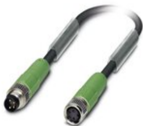
Sensor-/Aktor-Kabel, 4-polig, PUR halogenfrei, schwarzgrau RAL 7021, geschirmt, Stecker gerade M8, auf Buchse gerade M8, Kabellänge: 1,5 m
