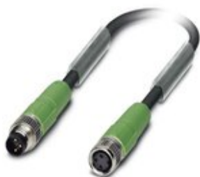
Sensor-/Aktor-Kabel, 3-polig, PUR halogenfrei, schwarzgrau RAL 7021, geschirmt, Stecker gerade M8, auf Buchse gerade M8, Kabellänge: 0,3 m
