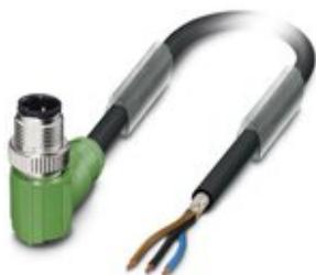
Sensor-/Aktor-Kabel, 3-polig, PUR halogenfrei, schwarzgrau RAL 7021, geschirmt, Stecker gewinkelt M12, Kodierung: A, auf freies Leitungsende, Kabellänge: 10 m
