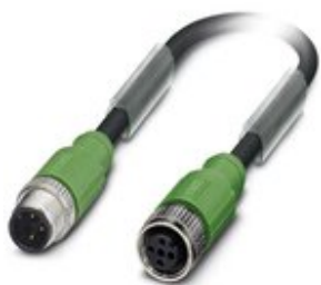
Sensor-/Aktor-Kabel, 3-polig, PUR halogenfrei, schwarzgrau RAL 7021, geschirmt, Stecker gerade M12, Kodierung: A, auf Buchse gerade M12, Kodierung: A, Kabellänge: 3 m
