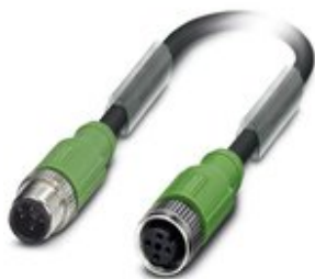
Sensor-/Aktor-Kabel, 4-polig, PUR halogenfrei, schwarzgrau RAL 7021, geschirmt, Stecker gerade M12, Kodierung: A, auf Buchse gerade M12, Kodierung: A, Kabellänge: 1,5 m
