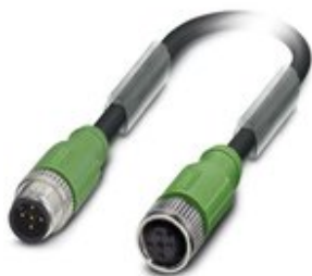
Sensor-/Aktor-Kabel, 5-polig, PUR halogenfrei, schwarzgrau RAL 7021, geschirmt, Stecker gerade M12, Kodierung: A, auf Buchse gerade M12, Kodierung: A, Kabellänge: 1,5 m
