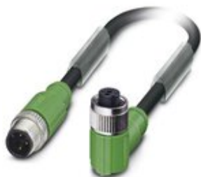
Sensor-/Aktor-Kabel, 3-polig, PUR halogenfrei, schwarzgrau RAL 7021, geschirmt, Stecker gerade M12, Kodierung: A, auf Buchse gewinkelt M12, Kodierung: A, Kabellänge: 3 m
