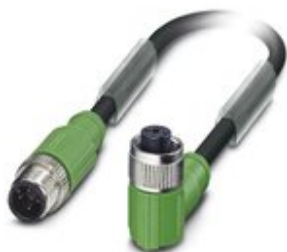
Sensor-/Aktor-Kabel, 4-polig, PUR halogenfrei, schwarzgrau RAL 7021, geschirmt, Stecker gerade M12, Kodierung: A, auf Buchse gewinkelt M12, Kodierung: A, Kabellänge: 0,6 m
