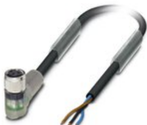
Kabel czujnika/urządzenia wykonawczego, 3-bieg., PCW, czarny RAL 9005, wolny koniec przewodu, na Gniazdo kątowe M8, z 2 LED, długość kabla: 5 m
