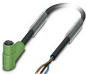
Sensor-/Aktor-Kabel, 3-polig, PUR halogenfrei, schwarzgrau RAL 7021, freies Leitungsende, auf Buchse gewinkelt M8 Snap-In, Kabellänge: 5 m
